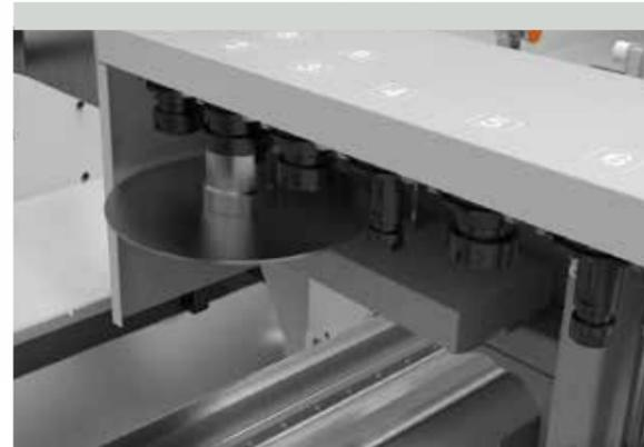
**CARRO VIGA EJE X** de acero electrosoldado, accionado por servomotor brushless de altas prestaciones que garantiza velocidades de hasta 100 m/min. En el carro puede montarse el dispositivo opcional de control y medición de la longitud herramienta.
