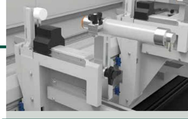
**SPANNVORRICHTUNGEN** aus Aluminiumguss mit automatisch gesteuerter Positionierung entlang der X-Achse mithilfe des aufrechten Rahmens oder unabhängig (optional). Auf Anfrage sind **Spannvor- richtungen mit Extra-Feststellung** aus Aluminium- guss erhältlich, bei denen das Schließen der Spannbacke (aus Gusseisen) mithilfe von Führungslinealen erfolgt.
