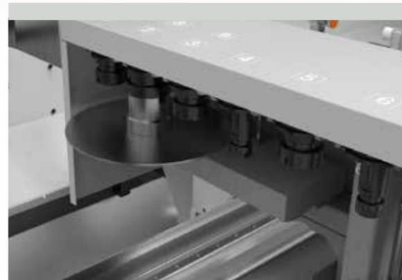
**WAGEN QUERTRÄGER X-ACHSE** aus elektroge- schweißtem Stahl, angetrieben von bürstenlosem Hochleistungsservomotor, der Geschwindigkeiten bis 100 m/min ermöglicht. Am Wagen kann auf Anfrage die Vorrichtung für die Unversehrtheitsprüfung und Messung der Werkzeuglänge montiert werden.
