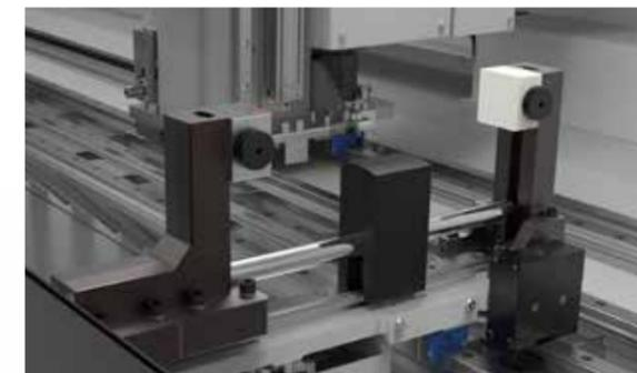
Per ampliare la capacità di serraggio ed i campi di lavoro sono disponibili **MORSE EXTRA SERRAGGIO** in fusione di ghisa in cui la chiusura della ganasce si realizza tramite guide lineari.
