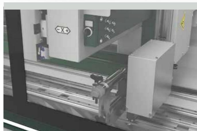
**TESTA DI LAVORAZIONE** consente di eseguire lavorazioni sulle 3 facce del profilo ad ogni angolazione tra 0° e 180° e sulle 2 testate. Il motore brushless consente eccezionali prestazioni in termini di accelerazione e velocità che collocano FMC 230 ai vertici della sua categoria.
