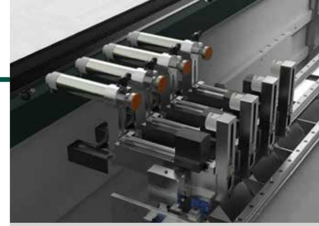
**MORSE** in fusione di alluminio con posizionamento automatico controllato lungo asse X tramite montante.
