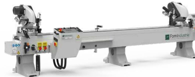
Rotación cabezales respecto del eje vertical
