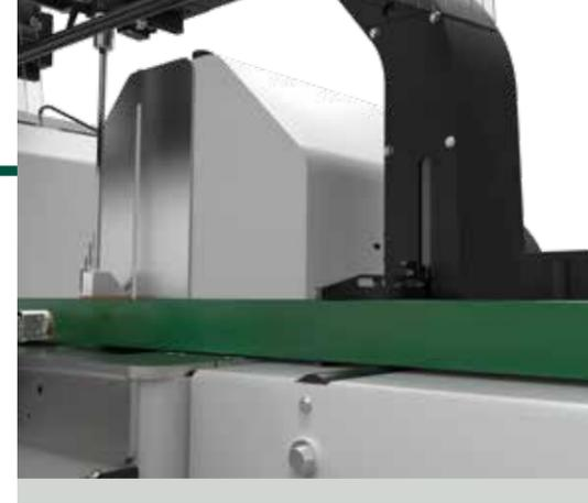
Le **MESUREUR ÉLECTRONIQUE** transmet la dimension de la hauteur du profil au contrôle, qui peut ainsi compenser automatiquement les tolérances d'extrusion en assurant le respect des cotes nécessaires pour obtenir une huisserie parfaite. La saisie de la cote est obtenue par le palpement de deux points et à l'aide d'un étai vertical afin que la mesure soit parfaite même en présence de défauts de linéarité ou de déformation de la barre.
