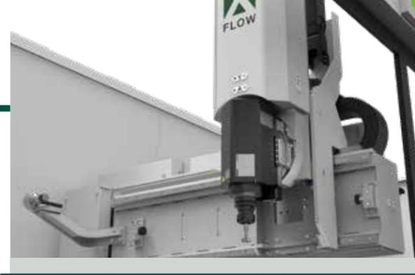
**CABEZAL DE MECANIZACIÓN** permite efectuar mecanizaciones en 3 caras y los 2 extremos del perfil, de tamaño compacto para reducir al máximo la necesidad de reposicionamiento, pero sumamente rígido para garantizar una calidad excelente.
