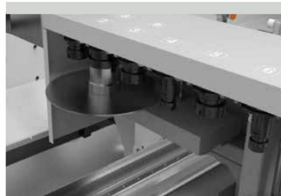
**DISPOSITIVO DE MEDICIÓN DE LA LONGITUD PERFIL** para medir la efectiva longitud del perfil y posicionar las mecanizaciones con precisión (accesorio opcional).
