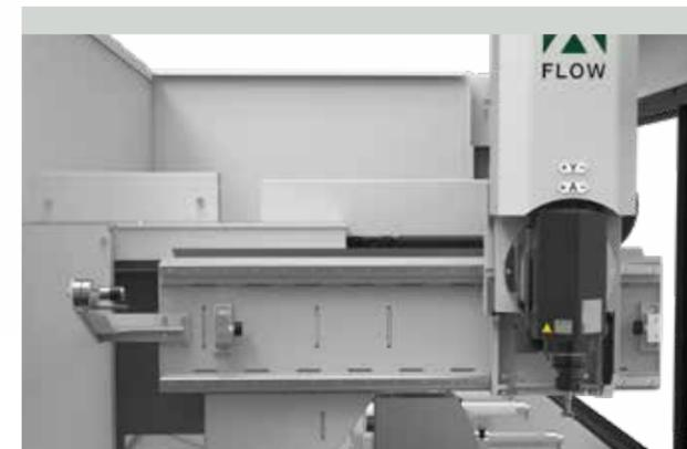
**CARTERIZZAZIONE** La linea ergonomica facilita le operazioni di carico e scarico e garantisce ampia visibilità durante le lavorazioni. Integrato nella carterizzazione, il **LOGO FOM Industrie** luminoso che indica lo stato macchina.
