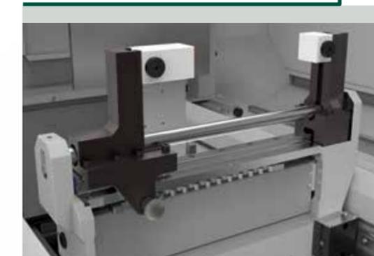
**DISPOSITIVO PER LA MISURAZIONE DELLA LUNGHEZZA BARRA** per rilevare la lunghezza reale del profilo e posizionare le lavorazioni con precisione (optional).
