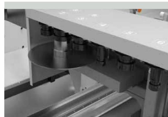
**CARRO TRAVE ASSE X** in acciaio elettrosaldato, è azionato da servomotore brushless ad alte prestazioni che assicura velocità fino a 100m/min. Sul carro può essere montato a richiesta il dispositivo di verifica e misurazione della lunghezza utensile.
