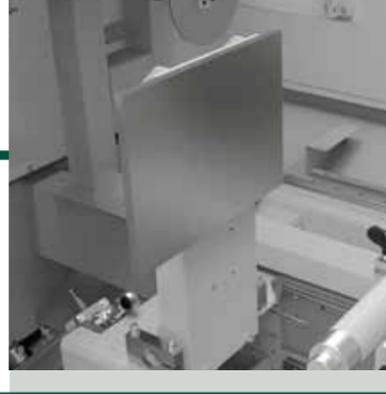
**PNEUMATISCH GESTEUERTER FESTANSCHLAG FÜR DIE STANGENPOSITIONIERUNG LINKS**
