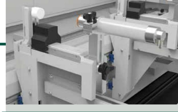
**SPANNVORRICHTUNGEN** aus Aluminiumguss mit automatisch gesteuerter Positionierung entlang der X-Achse mithilfe des aufrechten Rahmens (serienmäßig) oder unabhängig (optional). Auf Anfrage sind **Spannvorrichtungen mit Extra-Feststellung** aus Aluminiumguss erhältlich, bei denen das Schließen der Spannbacke (aus Gusseisen) mithilfe von Führungselementen erfolgt.
