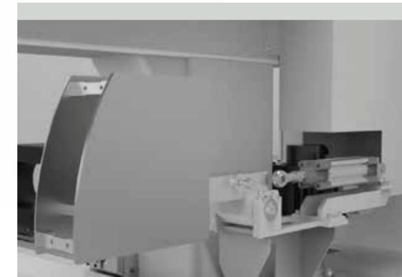
**MESSGERÄT FÜR DIE STANGENLÄNGE**
