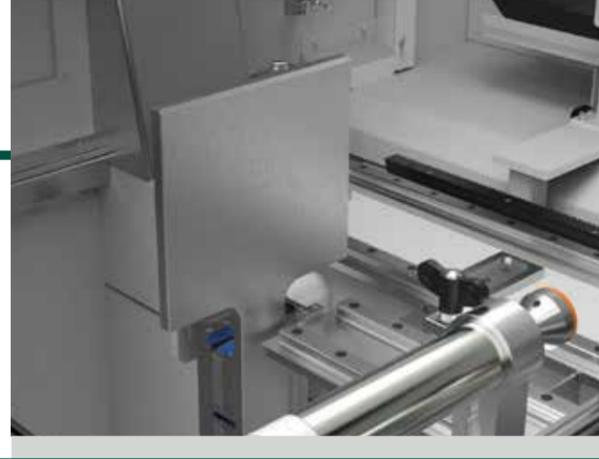
**BUTÉE POSITIONNEMENT BARRE FIXE GAUCHE COMMANDÉE PNEUMATIQUEMENT** (de série). Possibilité d'ajouter une deuxième butée à droite (option).
