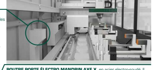
**POUTRE PORTE ÉLECTRO MANDRIN AXE X** en acier electro-soudé. Il est mobile sur guides linéaires a recirculation de sphères, un moteur brushless garantit des prestations élevées. Vitesse d'usinage jusqu'à 100 m/min.
